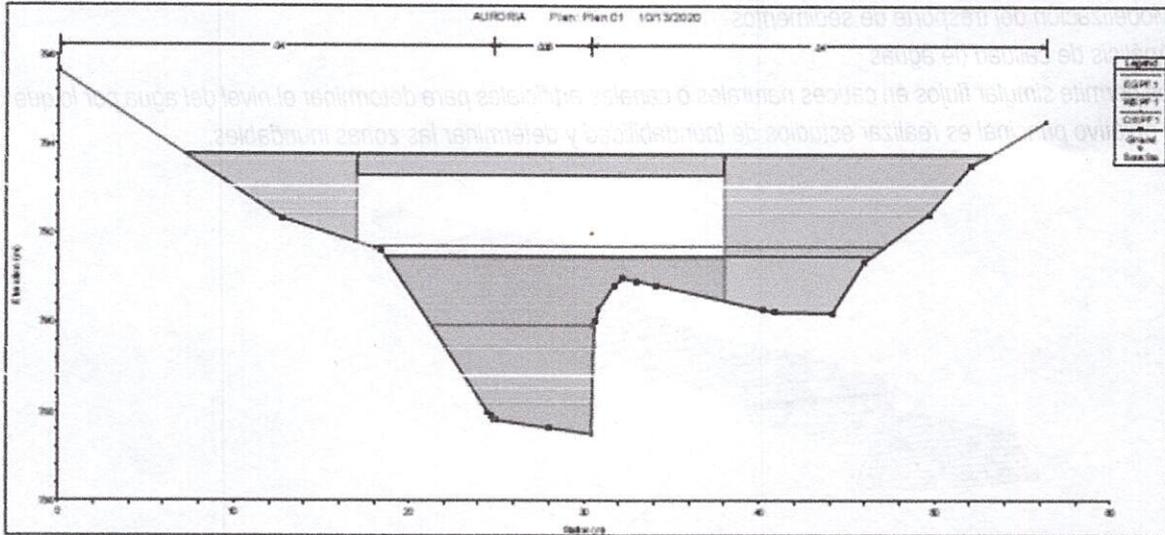
Figura: Sección del cauce en la estación del puente propuesto: 36 m
