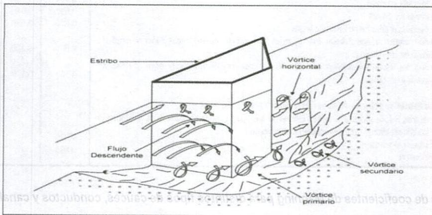
Figura: Socavación local de un estribo
