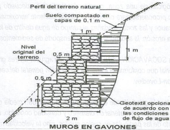
Figura: Esquema típico de muros de gaviones protección cauce.
